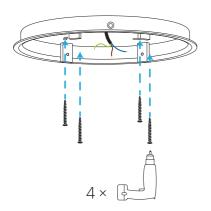
Die Auswahl der richtigen Befestigungsmittel obliegt dem Installateur. Keine schräge Deckenmontage zulässig.
