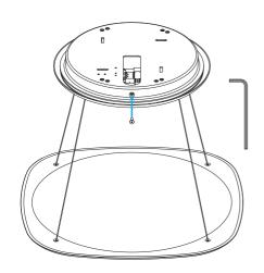
Die Schraube zum Sichern des Deckentopfes festziehen.
