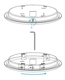
Die Senkschraube lösen. Das Deckenblech aus dem Bajonett herausdrehen und abnehmen.
