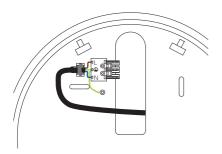
Das Kabel aus dem Deckenauslass in der Klemme anschließen und mit der Zugentlastung sichern.
