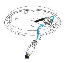
Die WAGO-Klemme aus dem Deckentopf an dem Deckenblech anschließen.
