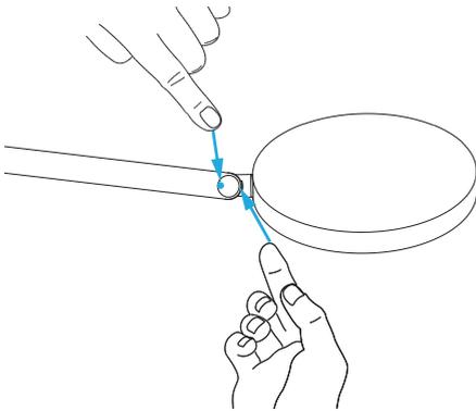
Das Kopfgelenk kann über eine kleine Schraube nachjustiert werden. Nehmen Sie dafür vorsichtig die Abdeckscheibe am Gelenk ab und ziehen Sie mit dem Imbusschlüssel die Schraube leicht an. Stecken Sie anschließend die Abdeckscheibe wieder auf das Gelenk.
