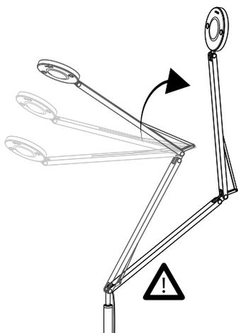
Beim Transport der Leuchte bitte Fuß und Leuchte festhalten, damit diese nicht durch einen Überschlag nach hinten beschädigt wird!
